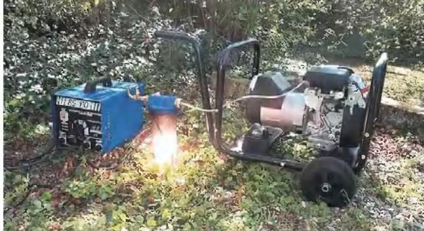
**Электростанция уверенно работает на газах, получаемых от реактора.**
